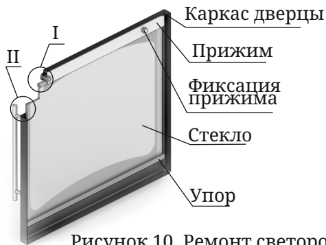
Рисунок 10. Ремонт светорозрачного экрана дверцы модификации «Витра»
