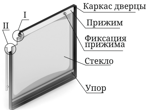
Рисунок 14. Ремонт светопрозрачного экрана дверцы модели «Витра»
