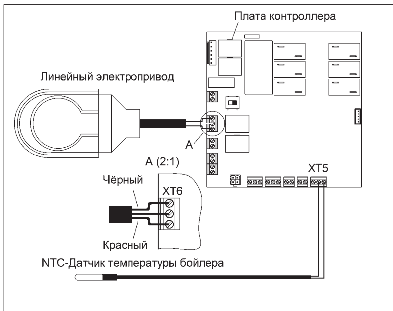
Рисунок 30. Схема подключения модуля ГВС EVAN-AQUA
