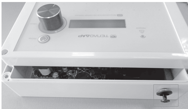
Рис. 6. Удаление заглушки из отверстия для антенны
