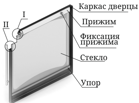
Рисунок 10. Ремонт светопрозрачного экрана дверцы модели «Витра»
