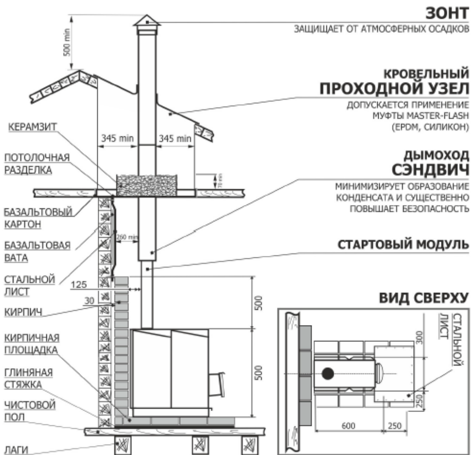
Рисунок 2 — Монтаж печи серии Т (1.1)
